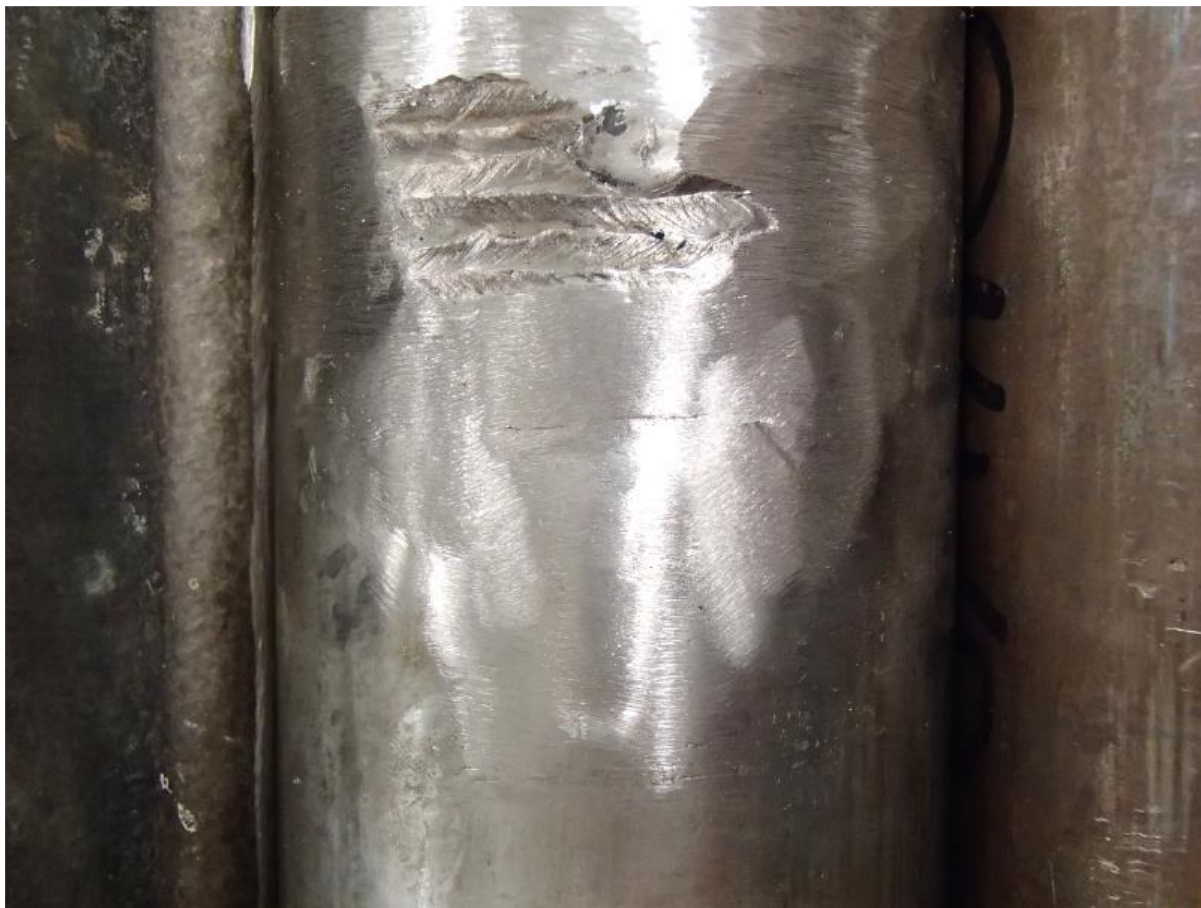
Figur 8. Ett annat exempel där man valt att slipa påsvetsningen ännu mer jämn, men ändå behållit en oslipad del för att underlätta framtida av lokaliseringsmöjligheter.
