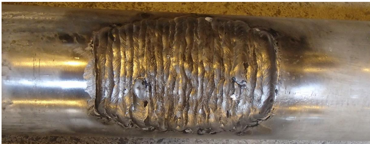
Figur 6. Exempel på färdig påsvetsning av ett område av omkring 75x50 mm (den största rekommenderade lagningsytan).
