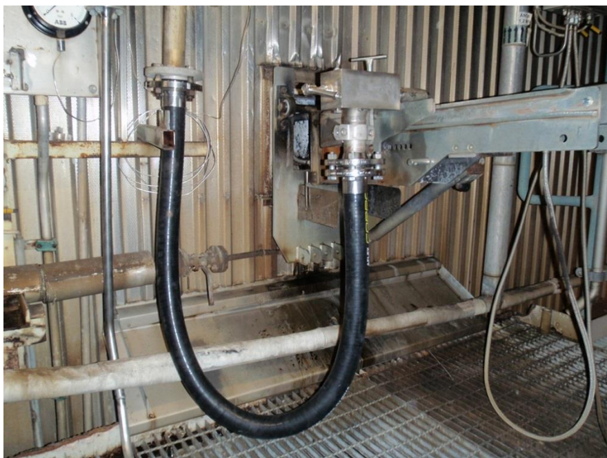
Bild 2 Anslutande slang för lut är fast monterad för minimal påverkan och slitage på slang i samband med sprutbyte.
