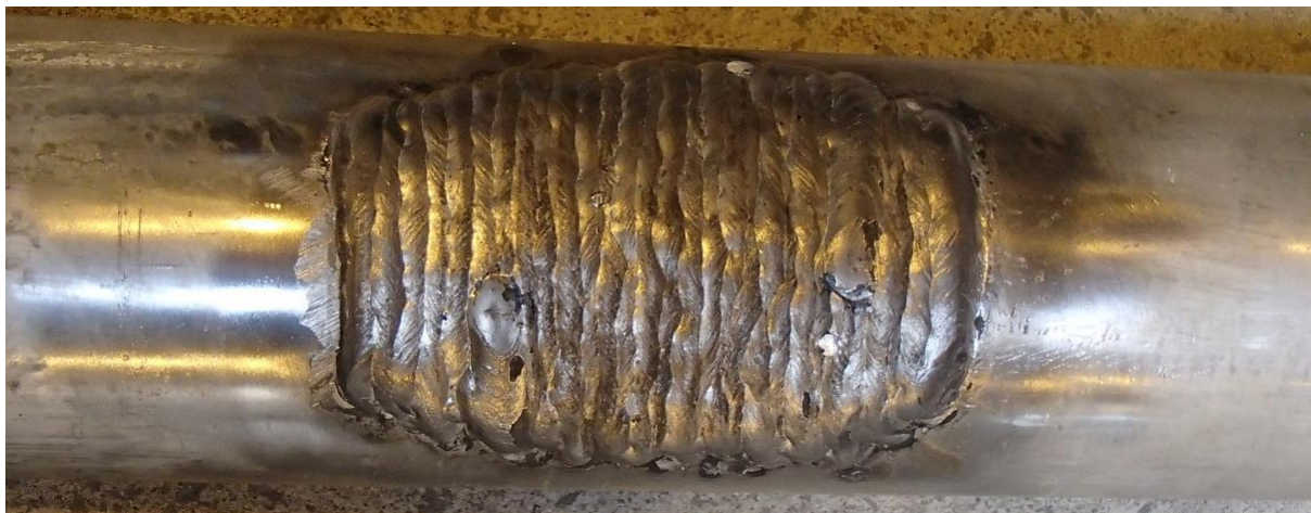
Figur 3. Exempel på färdig påsvetsning av ett område av omkring 75x50 mm (den största rekommenderade lagningsytan).
