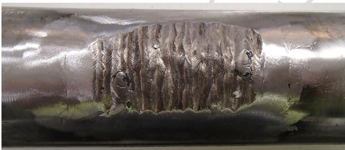
Fig. 7. Ett exempel på hur man slipat övergången mellan svetsen och tuben för att minska spänningskoncentrationerna. Sida 8 av 9
