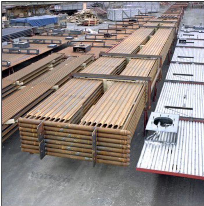
Paneler till ekonomisern i Gruvöns SP5 (Kvaerner Pulping)
