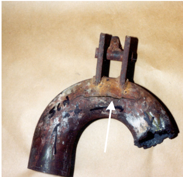
Övre böj med spricka, primäröverhettare I, Munksund
