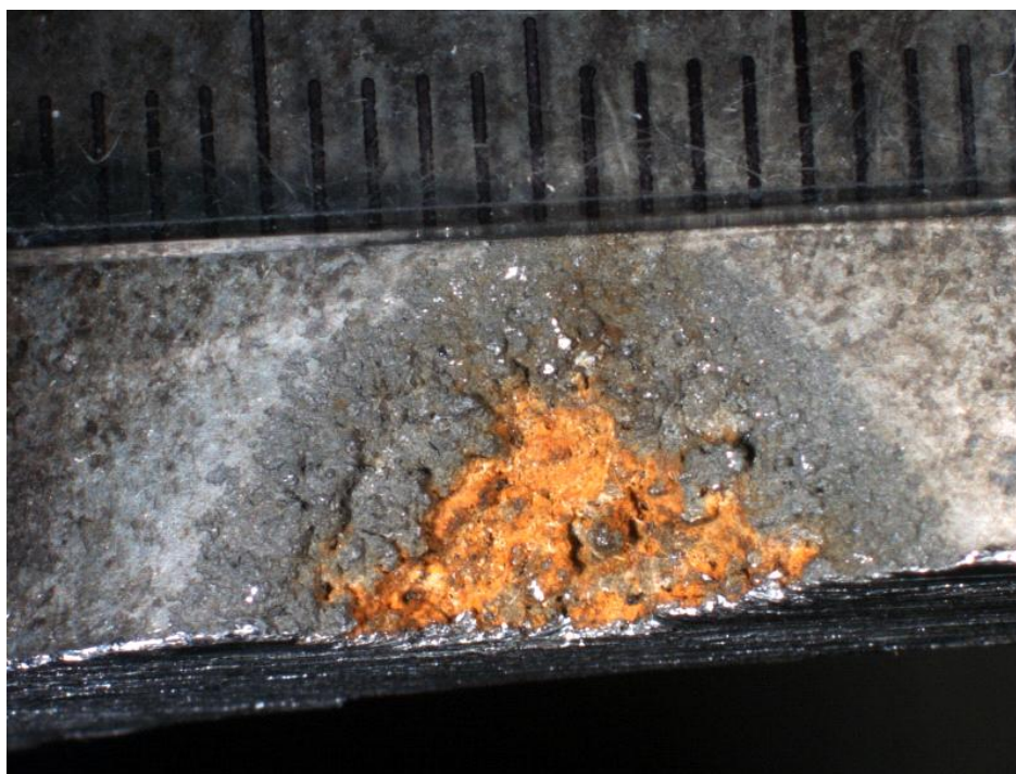
Fig. 8 Den större skadan på tub 51 från sodapannan. Skadans bredd var ca 13 mm.
