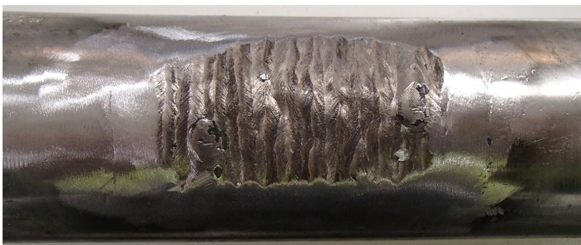
Figur 4. Ett exempel på hur man slipat övergången mellan svetsen och tuben för att minska spänningsskoncentrationerna.
