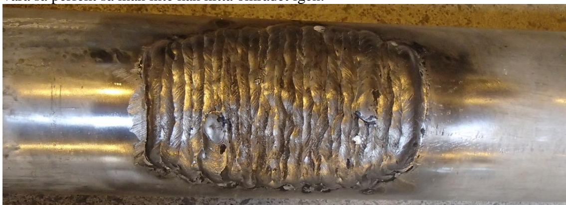
Figur 3. Exempel på färdig påsvetsning av ett område av omkring 75x50 mm (den största rekommenderade lagningsytan).
