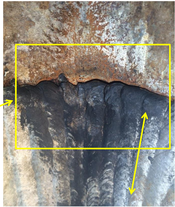
Figur 4... hade grövre strängar av påsvetsning längs med rännan
