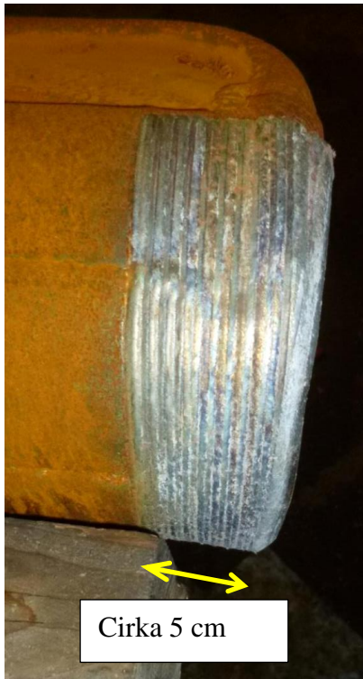
Figur 16 Detta fotografi är taget underifrån löprännan vid smältautloppet för att visa att den är korrosionsskyddad även cirka 5 cm på underkanten eftersom smältan inte släppte
