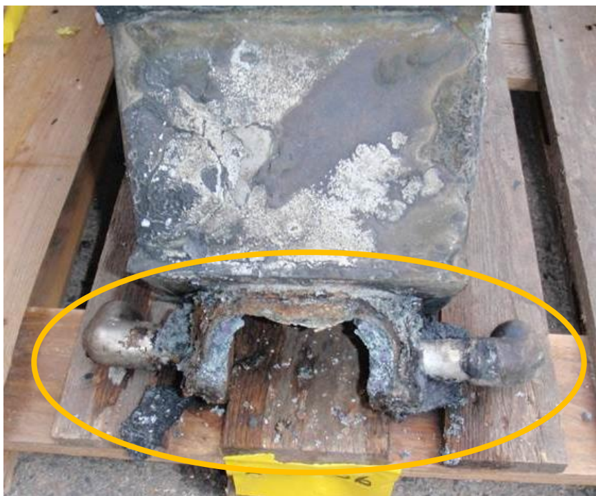
Figur 2 När/om det nedersta kylsystemet springer läck stänger man av kylvattenflödet till denna del låter "nästippen" brinna upp.
