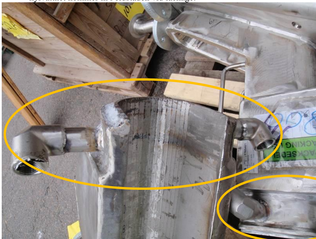
Figur 1 BillerudKorsnäs Gävle SP4 och SP5 har ett extra kylsystem cirka den nedersta decimetern
