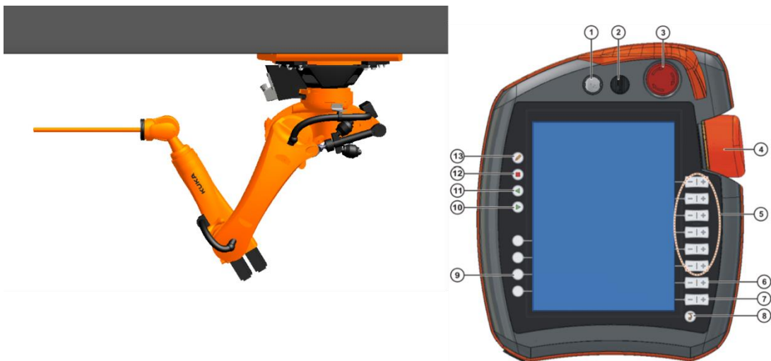
Bild: Löprännerrobot i Södra Cell Mörrum. Robot och styrenhet.
