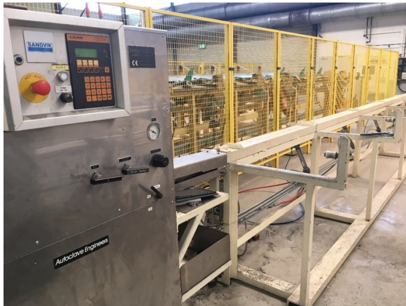
Figur 6. Bild på utrustningen för vattentrycksprovning.
