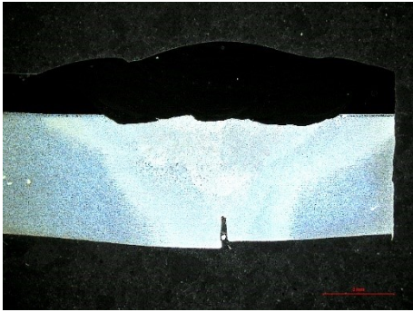
Figur 24. Tvärsnitt av svets 3 med rotfel (8X). Rotfel uppmätt till 1,2 mm.
