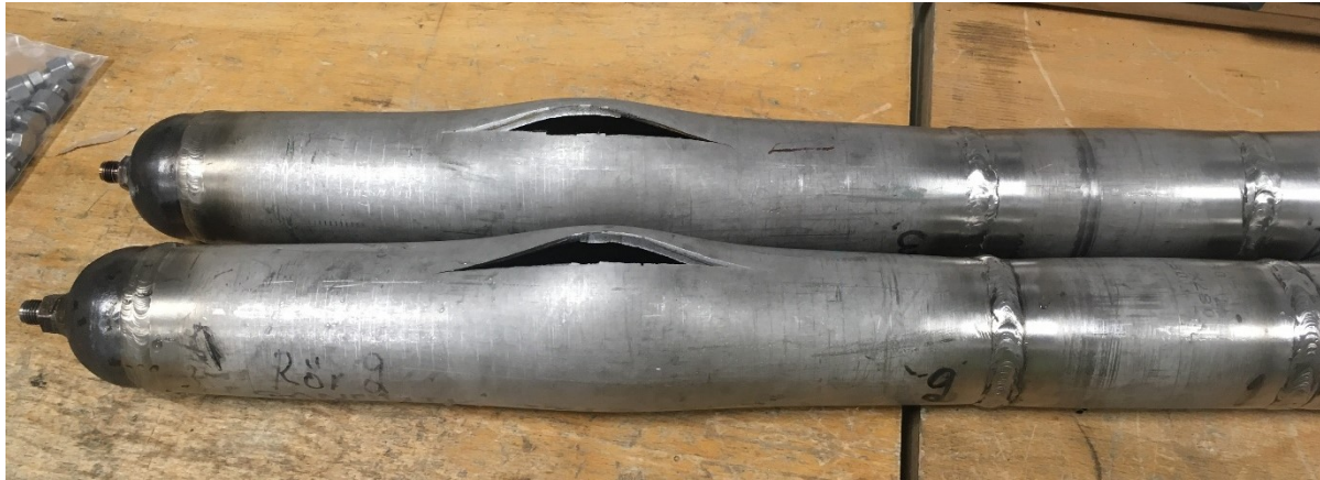
Figur 10. Längsgående sprickor i båda rören efter vattentrycksprovning.
