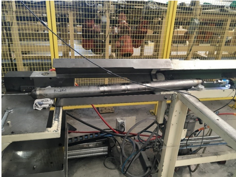
Figur 7. Bild på ett av rören monterat innan provning.
