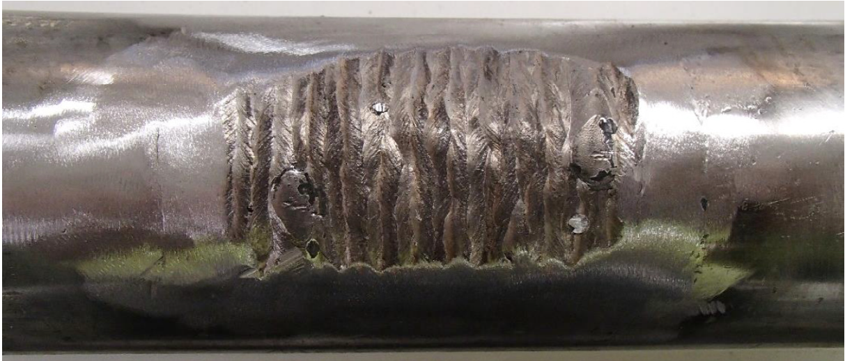
Fig. 3. Ett exempel på hur man slipat övergången mellan svetsen och tuben för att minska spänningskoncentrationerna. Sida 8 av 9
