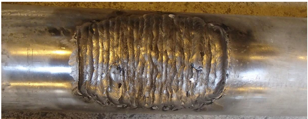
Fig. 2. Exempel på färdig påsvetsning av ett område av omkring 75x50 mm (den största rekommenderade lagningsytan).
