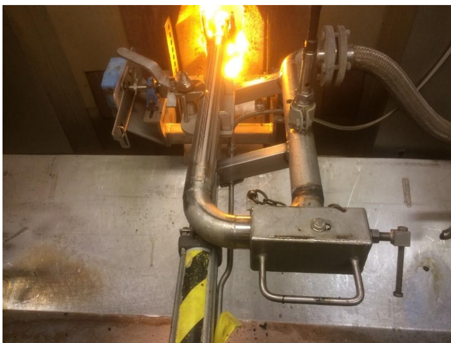
Bild 6 Fast spruta med en skyddande handske med låssprint över flänskopplingen. Anslutande slang för lut är fast monterad för minimal påverkan och slitage på slang i samband med sprutbyte. Operatören är skyddad mot eventuellt läckage i anslutningen mellan böj och lutsprutan.
