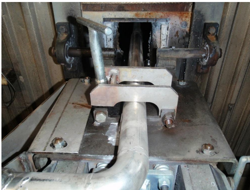
Bild 1 Fast spruta med låsning för att minimera påverkan av flänskopplingen vid nedfallande kemikaliekulor i eldstaden.
