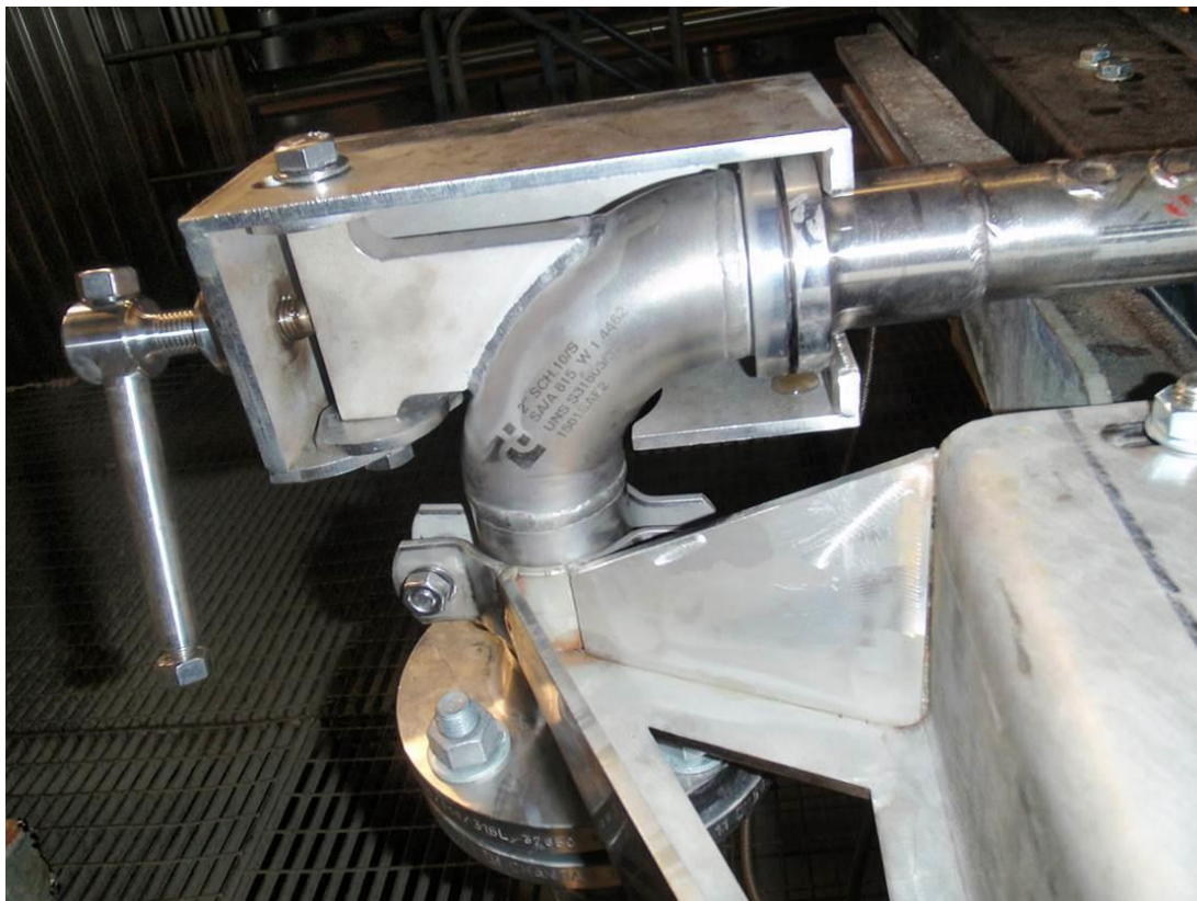
Bild 3 Operatören är skyddad mot eventuellt läckage i anslutningen mellan rörböjen och lutsprutan. Eventuellt kvarvarande tryck kan säkert evakueras genom att kopplingen lösgörs på ett kontrollerat sätt genom att den gängade stången försiktigt lossas.
